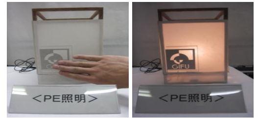
同印刷技術を行灯の非接触スイッチ回路に応用
